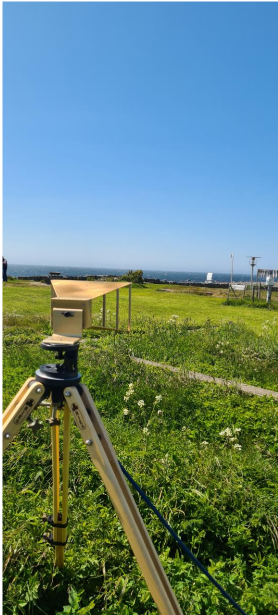
Bilde 2. Viser måleantenne i MP1 100m fra radaren.
