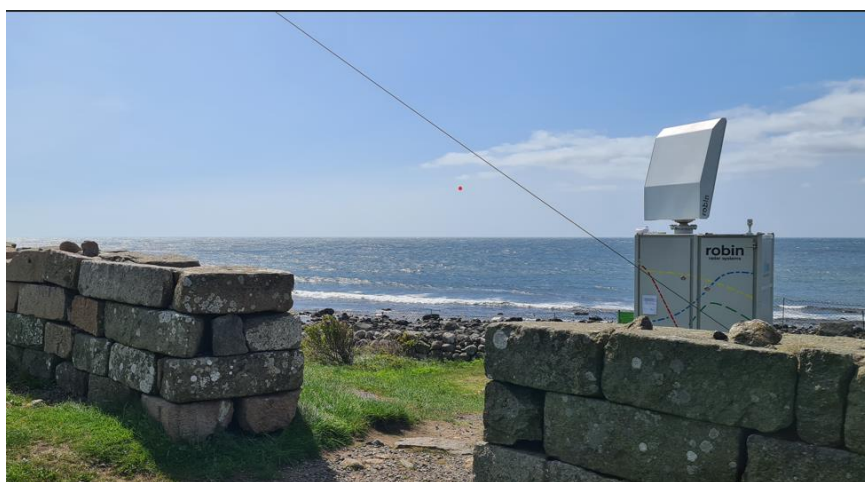
Bilde 1. Fugleradaren slik den er plassert i terrenget.
